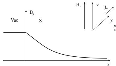
Рисунок 15. Проникновение статического магнитного поля в сверхпроводник
