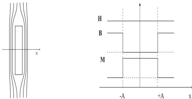
Рисунок 7. Распределение магнитного поля вблизи длинного тонкого цилиндра
