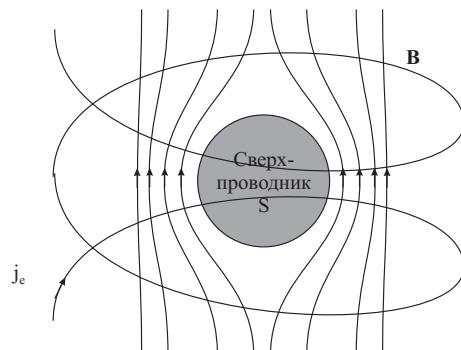
Рисунок 6. Типичная схема эксперимента по воздействию магнитного поля на сверхпроводник. По внешней катушке течет ток  $\mathbf{j}_e$ , по образцу  $-\mathbf{j}_i$
