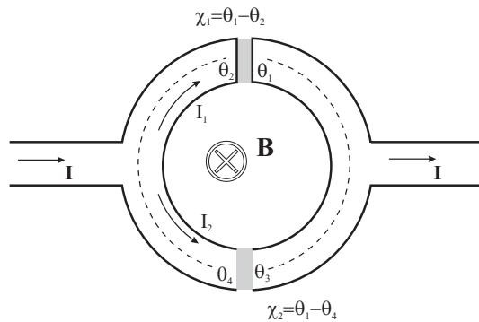
Рисунок 48. Двухконтактный СКВИД
