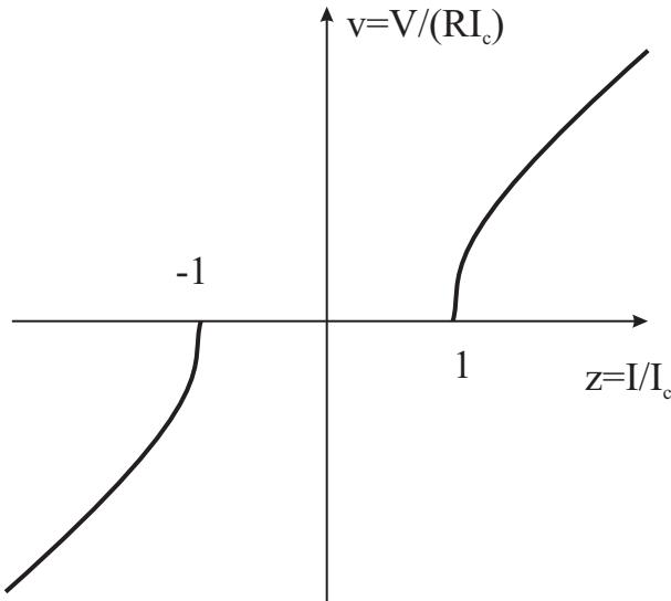
Рисунок 39. Вольт-амперная характеристика джозефсоновского контакта с малой емкостью
