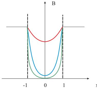
Рисунок 17. Проникновение статического магнитного поля в слой сверхпроводника конечной толщины, параметр  $\zeta \ll 1$  для верхней кривой,  $\zeta \sim 1$  -для средней, и  $\zeta \gg 1$  для самой нижней
