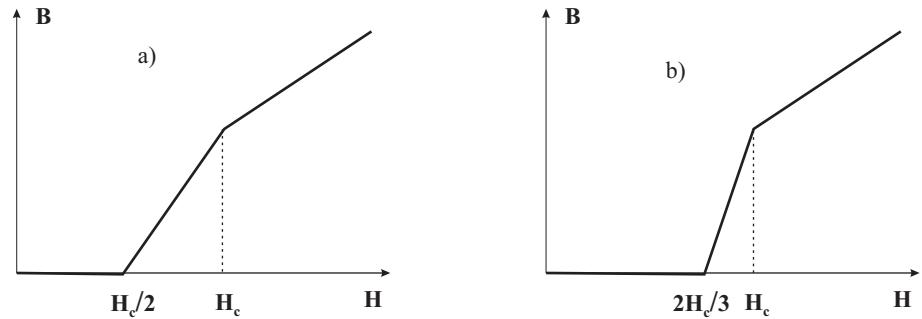
Рисунок 10. Кривые намагнченности цилиндра а), и сферы б) в однородном поле с учетом существования промежуточного состояния
