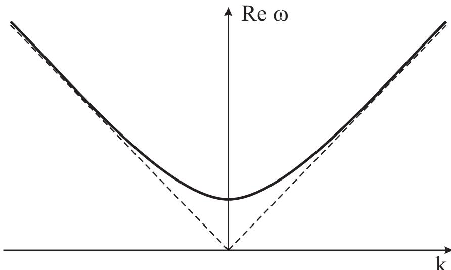
Рисунок 45. Дисперсия электромагнитных волн в джозефсоновском контакте
