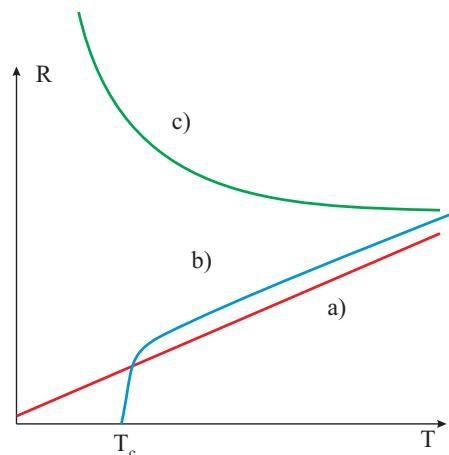
Рисунок 1. Характерная зависимость сопротивления металлов и полупроводников от температуры. а)- металл с конечным остаточным сопротивлением, б) - сверхпроводящий металл, в) - полупроводник
