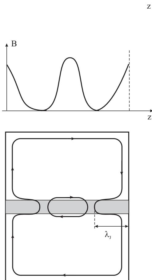
Рисунок 44. Проникновение магнитного поля в джозефсоновский переход
