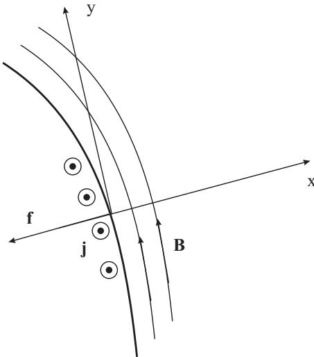
Рисунок 5. Распределение магнитного поля и тока вблизи поверхности сверхпроводника
