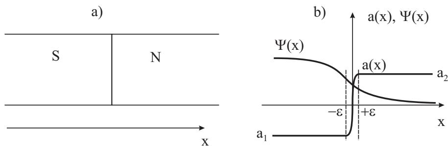
Рисунок 22. Эффект близости - проникновение сверхпроводимости в нормальный металл, a)-граница сверхпроводника и нормального металла, b)-поведение параметра  $a(x)$  и параметра порядка  $\Psi(x)$
