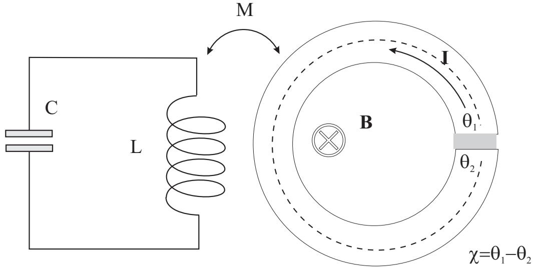
Рисунок 46. Одноконтактный СКВИД или СКВИД переменного тока
