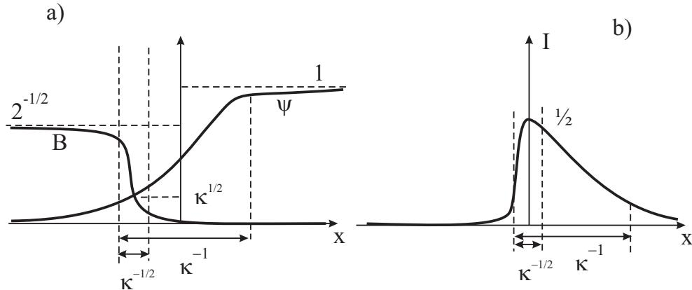
Рисунок 33. Зависимость магнитного поля и параметра порядка -а) и плотности свободной энергии - б) от координаты в окрестности равновесной NS границы для малого  $\kappa = \lambda/\xi \ll 1$
