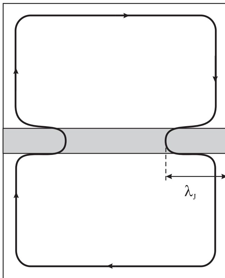
Рисунок 42. Экранирование слабого магнитного поля в джозефсоновском контакте
