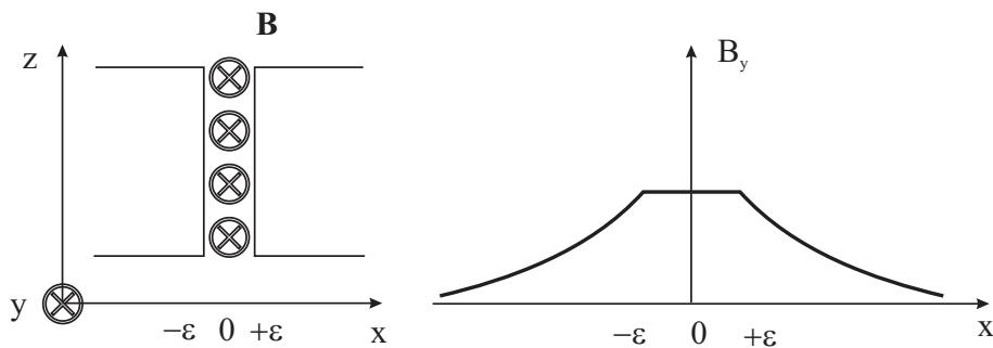
Рисунок 40. Джозефсоновский контакт с внешним магнитным полем
